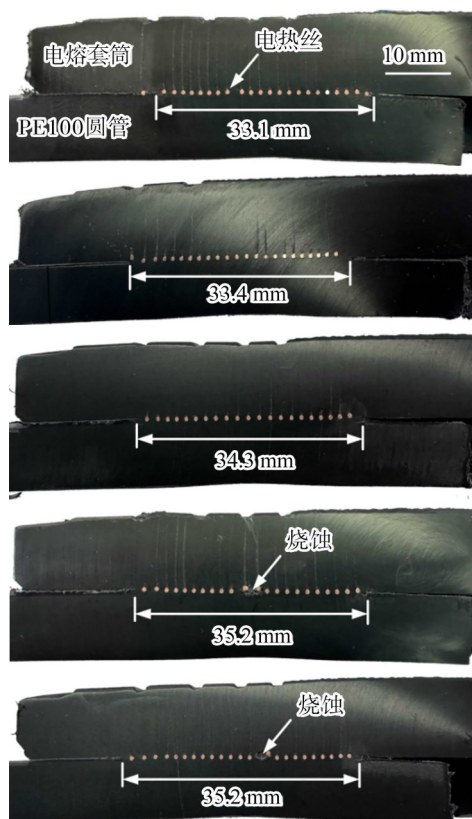
图4 PE100圆管电熔焊接头界面宏观形貌
