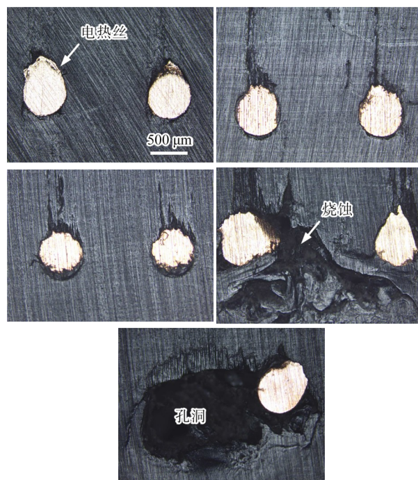
图5 PE100圆管电熔焊连接界面中心区域微观形貌
