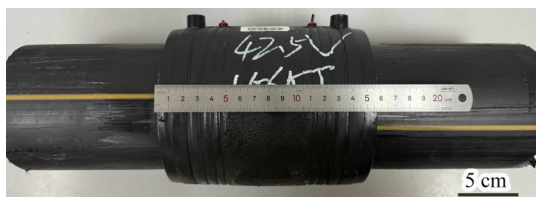
图2 PE100圆管电熔焊接头
