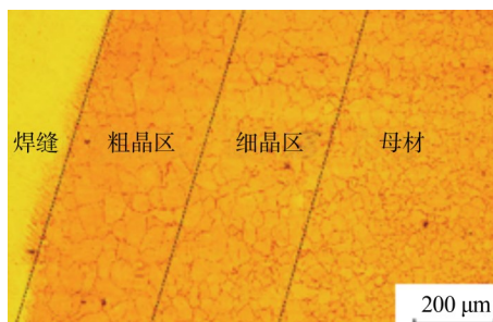
图11 SMAW焊缝及热影响区显微组织
