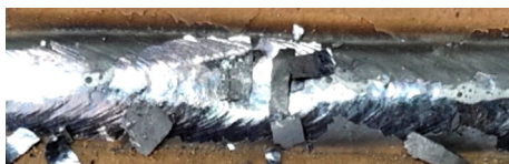
图5 焊道表面压铁液现象
