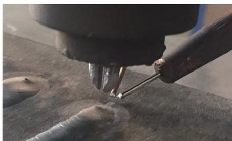
图2 双丝双钨极 TIG 电弧增材制造的送丝方位与钨极排布方式
