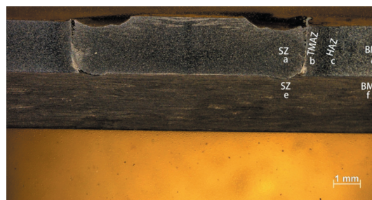
图9 回填式搅拌摩擦点焊接头横截形貌
