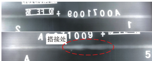
图5 5 mm 30CrMnSi 模拟件 X 射线探伤照片
