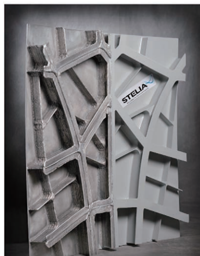
图 14 Stelia 航宇公司自加强铝合金 WAAM 壁板 Fig.14 Self reinforced aluminum alloy WAAM wallboard of Stelia Aerospace Company
