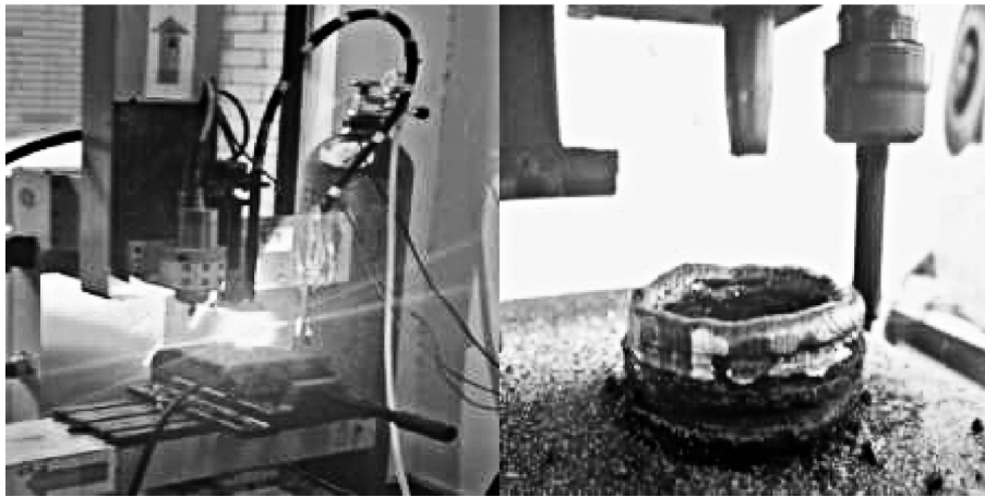
图8 混合铣削的电弧增材制造 [26]
