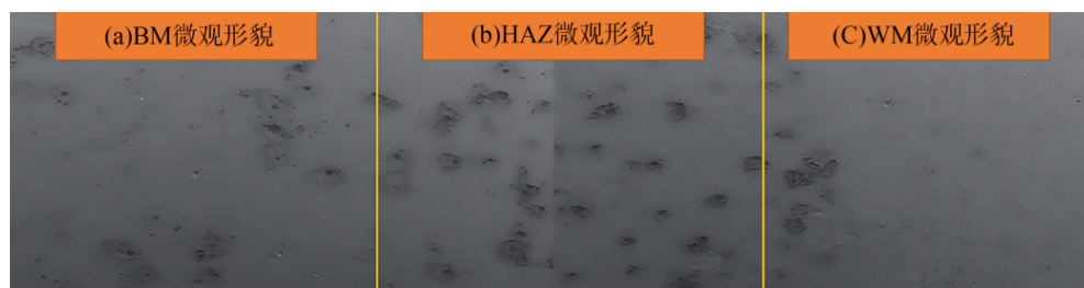
图 11 在海水中浸泡3天后焊接接头表面的微观形貌
