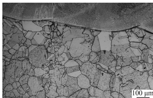
图5 激光修复试块金相
