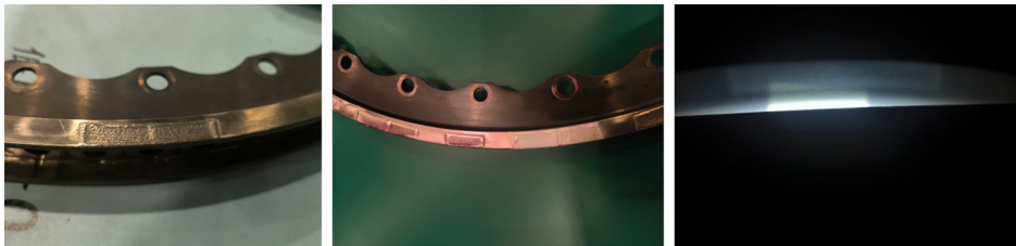
图 6 激光沉积增材修复目视、无损检测
