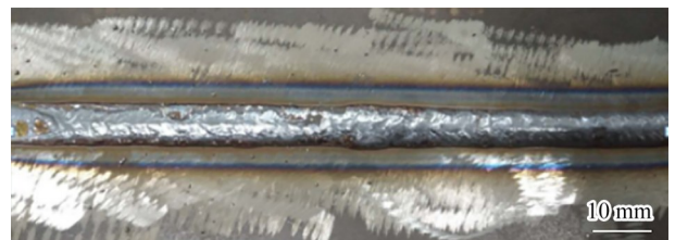
图7 潜弧焊接焊缝照片
