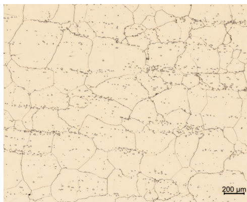
图1 GH3535合金的微观结构
