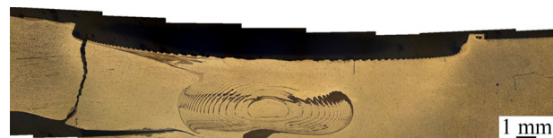
图4 断裂在HAZ的FSW接头样品横截面宏观形貌
