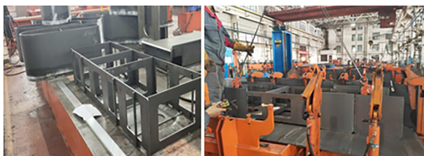
图4 端部一次组装
