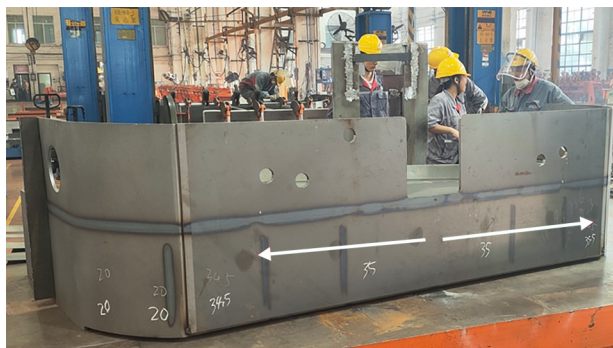
图7 端部一次火焰矫正方向示意
