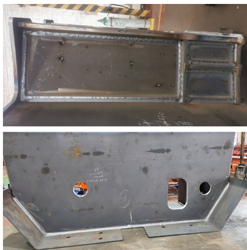
图13 端部机械手焊缝成形
