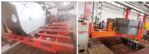
图3 端部一次及端部二次机械手焊接夹紧工装
