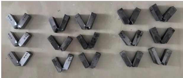
图 11 冲击试样断裂宏观
