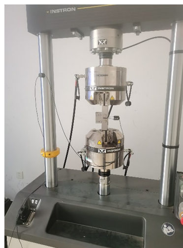
图2 疲劳裂纹扩展试验
