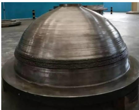
图3 通过电熔增材技术制造的反应堆压力容器
