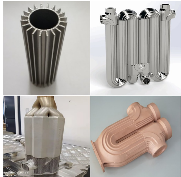
图4 核领域增材制造换热器研制
