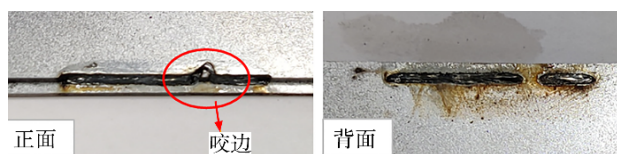
图10 错边量2 mm的焊缝外观照片(焊接速度60 mm/s)
