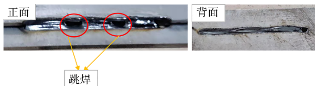
图18 焊接速度80 mm/s焊缝外观照片(搭接间隙0.5 mm)
