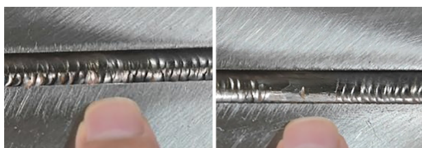
图 27 焊缝表面粗糙度过大
