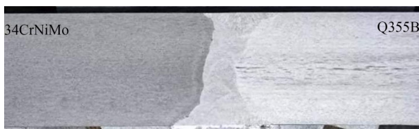
图2 焊缝低倍形貌
