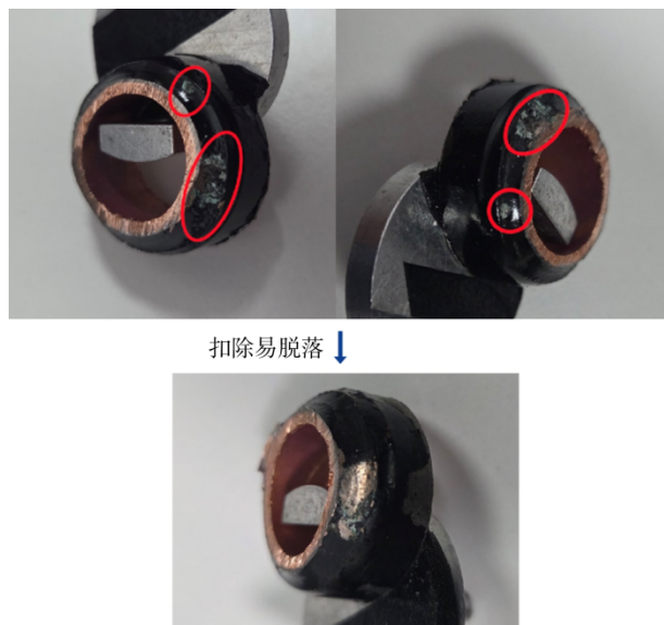
图 1 高频焊接压缩机三铜管, 涂装后放置几天, 焊缝处出现铜绿
