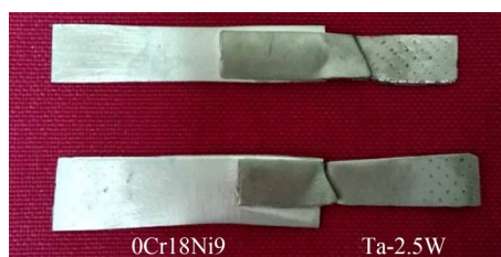
图12 拉剪断裂的炉中钎焊Ta-2.5W/ Ni_{82.5}Cr_7Fe_3Si_{4.5}B_3 /0Cr18Ni9接头形貌 [31]
