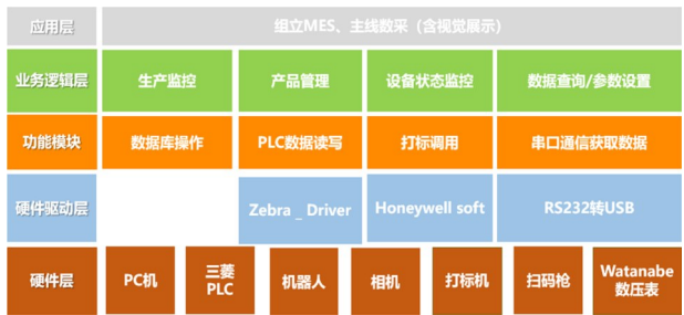
图 2 汽车零部件焊接生产线数据采集架构
