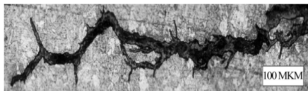
图4 扎波罗热核电站2号蒸汽发生器焊接接头№111中的裂纹片段
