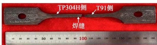
图7 断裂试样宏观照片
