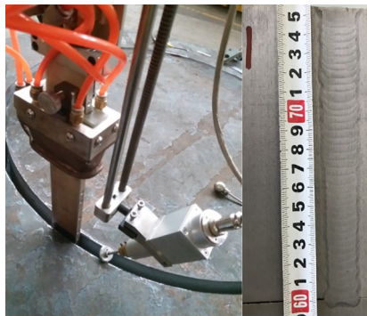
图8 模拟试验件焊接及检测
