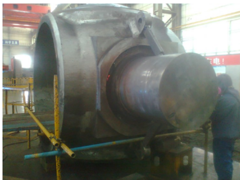
图2 活门阀轴人工焊接实拍
