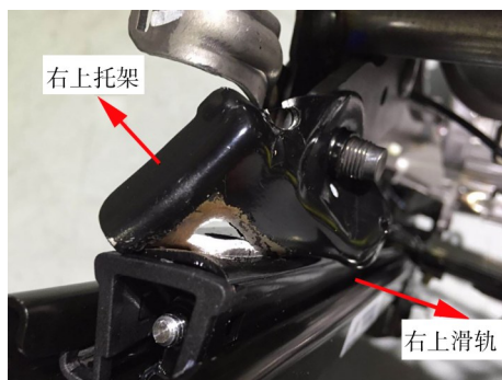
图1 汽车座椅激光焊接撕裂失效问题
